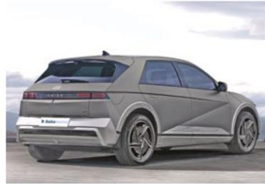
Com dois motores elétricos, o Ioniq 5 tem 325 cavalos de potência
