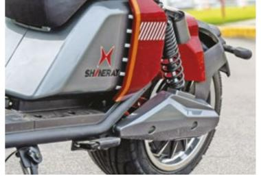
A PT4-Pro S 2025 está equipada com um motor elétrico indutivo brushless com potência nominal de 3 mil watts
