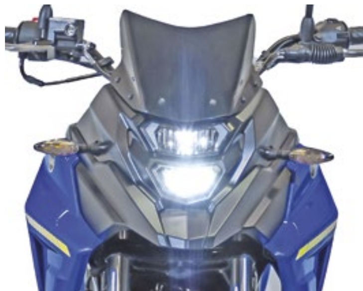
Foram mantidos na linha 2025 os destaques que o modelo já oferecia, como o conjunto de iluminação full-led, painel full-digital e carregador USB
