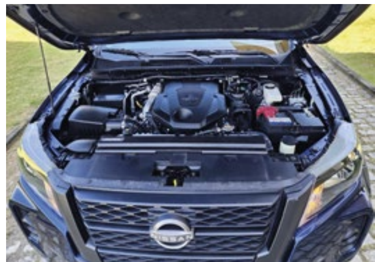
A versão Attack da Frontier é equipada com o motor diesel biturbo de 190 cavalos de potência e 45,9 kgfm de torque
