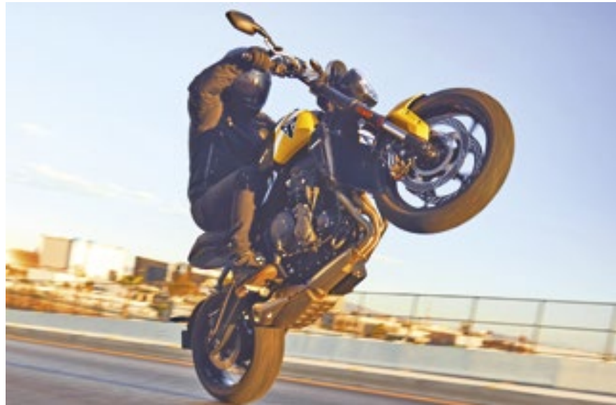
No motor de três cilindros, a potência de 81 cavalos está disponível a 10.250 rpm e mais de 90% do torque máximo de 6,5 kgfm é entregue de 3.600 a 9.750 rpm
