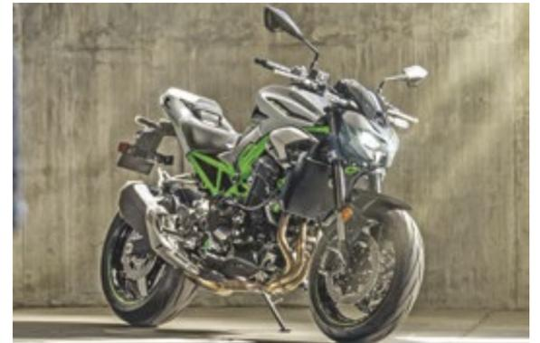
O sistema de suspensão foi revisado, incorporando um garfo invertido na dianteira e um monoamortecedor traseiro com link
