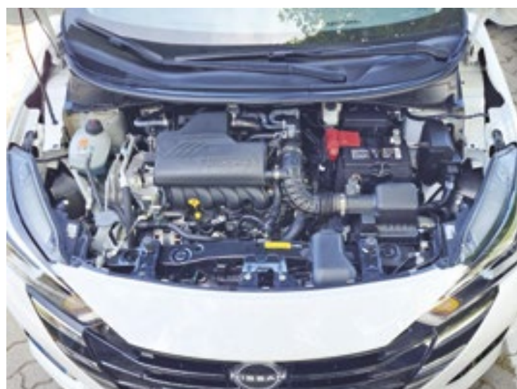
Como em toda a linha Versa, o motor 1.6 16V de quatro cilindros aspirado com 113 cavalos e 15,3 kgfm da versão é destaque
