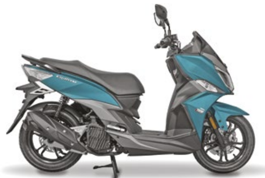
A linha 2025 da Cruisym 150 manteve as proporções do ano/modelo anterior – com 1,99 metro de comprimento, 1,35 metro de entre-eixos, 1,11 metro de altura e 78,5 centímetros de largura
