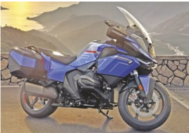
O modelo é movido pelo novo motor boxer de 1.300 cm³ da GS e da GS Adventure, que proporciona 145 cavalos a 7.750 rpm e 15,2 kgfm a 6.500 rpm
