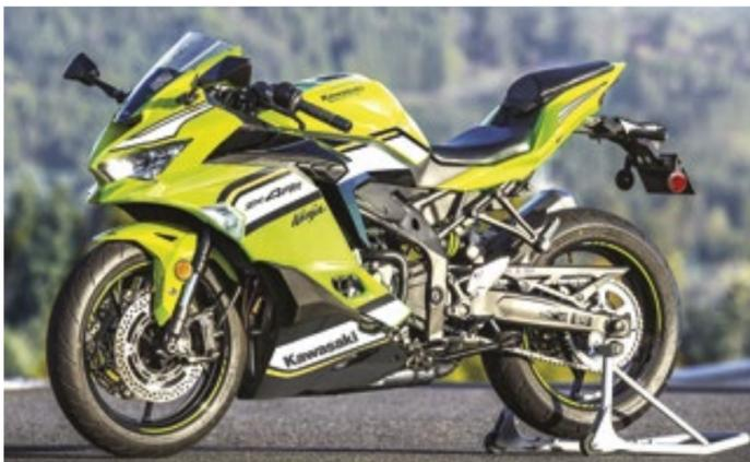
O motor DOHC de 399 cm<sup>3</sup>, com quatro cilindros em linha e 16 válvulas, atinge rotações superiores a 15 mil giros e gera até 77 cavalos de potência
