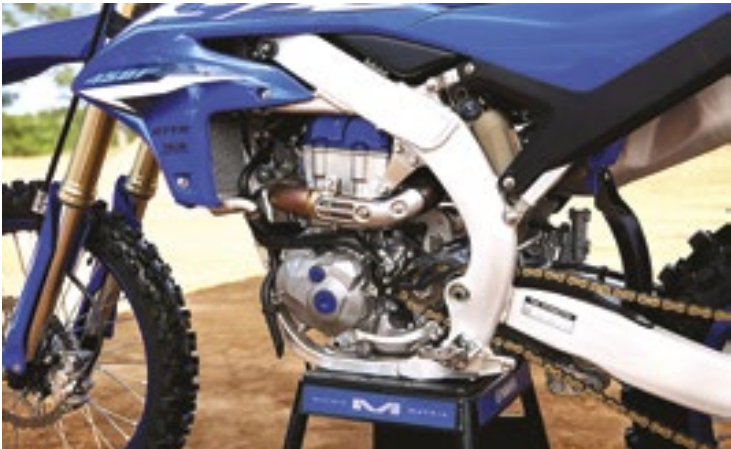
YZ450F tem sistema de partida elétrica compacto para reduzir atrasos na reinicialização e adicionar conveniência
