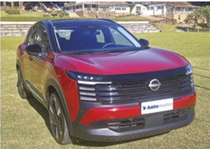
Nissan Kicks tem motor triclíndrico 1.0 turbo bicomcombustível com injeção direta multiponto, que entrega 125 cavalos e 22,4 kgfm
