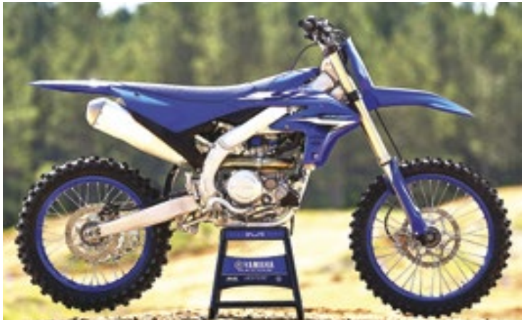
Novo quadro da YZ450F 2026 recebeu ajustes de rigidez e flexibilidade, melhorando a estabilidade e o contorno nas curvas
