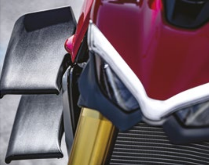
As asas frontais biplanas da Streetfighter reduzem a flutuação da roda dianteira em alta velocidade, evitando que ela se levante
