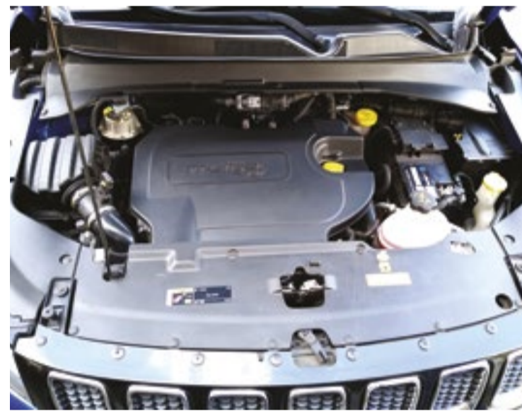
O motor do Jeep Compass é um 2.0 turbodiesel com injeção eletrônica e transmissão automática de 9 marchas
