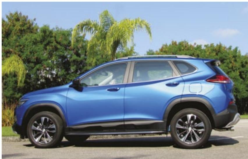
O modelo tem 4,27 m de comprimento, 1,62 m de altura, 1,79 de largura e 2,57 de entre-eixos, com porta-malas de 393 litros
