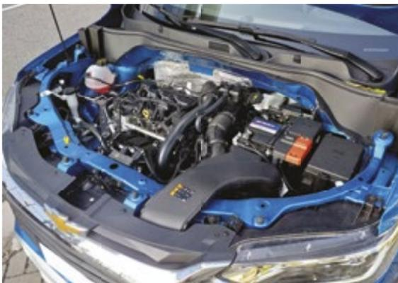
O motor da Tracker 1.2 Turbo Premier três cilindros 1.2 flex com turbocompressor, e vem com câmbio automático de seis marchas
