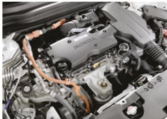
Sistema alterna automaticamente entre os motores; nos modos “EV Drive” e “Hybrid Drive”, tração ocorre por meio do motor elétrico
