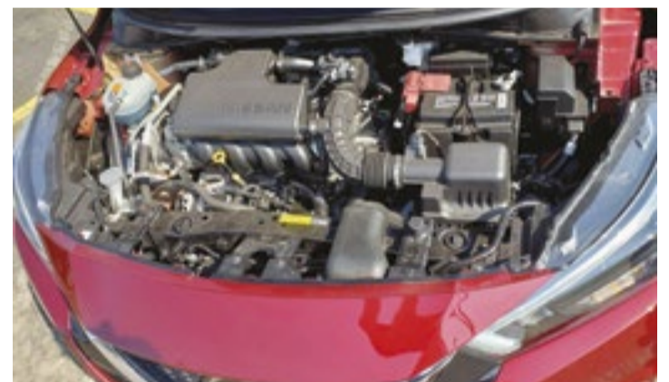
Sob o capô do Versa, o motor é o mesmo do Kicks, um 1.6 de quatro cilindros flex de 114 cavalos e 15,5 kgfm
