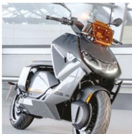
A CE 04 tem uma célula de bateria de 60,6Ah (8,9kWh), que traz alcance de 130 quilômetros
