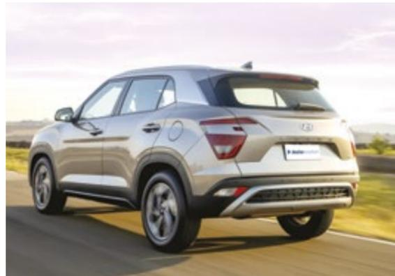
Novo Creta possui 4,30 m de comprimento, 1,79 m de largura, 1,62 m de altura e 2,61 m de distância de entre-eixos
