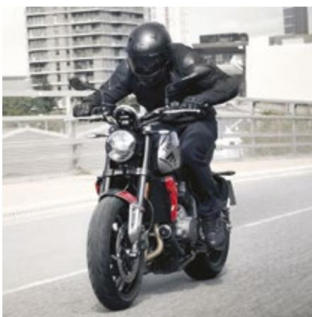
A roadster Trident 660 traz um novo motor de três cilindros, de 660cc, com 80 cavalos (a 10.250 rpm)
