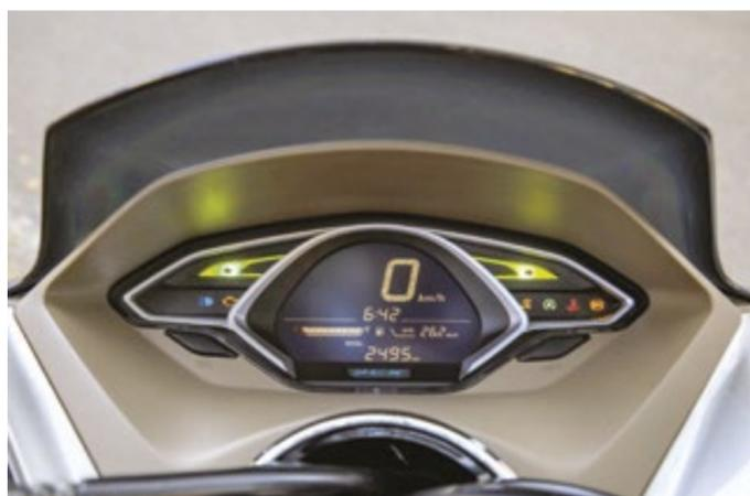
O painel da motocicleta Honda PCX versão 2022 possui display tipo Blackout. Já a iluminação é obtida por leds nas DRL, no farol e na lanterna
