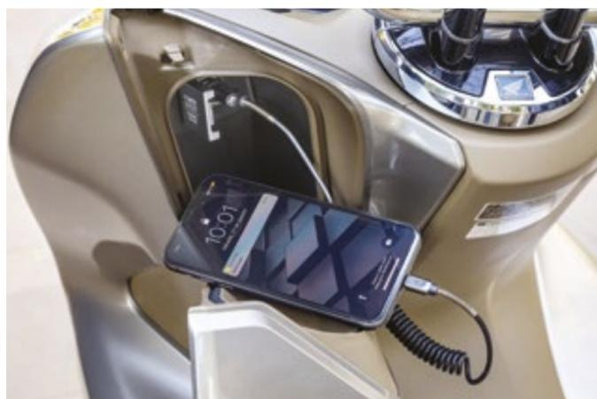
O compartimento sob o banco conta com 28 litros de capacidade e um prático sistema de abertura por meio de tecla, além de compartimento com tomada de 12V
