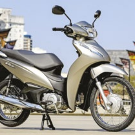
A Biz 110i, que tem o prata metálico como uma das novas cores, usa rodas raiadas, com freios a tambor
