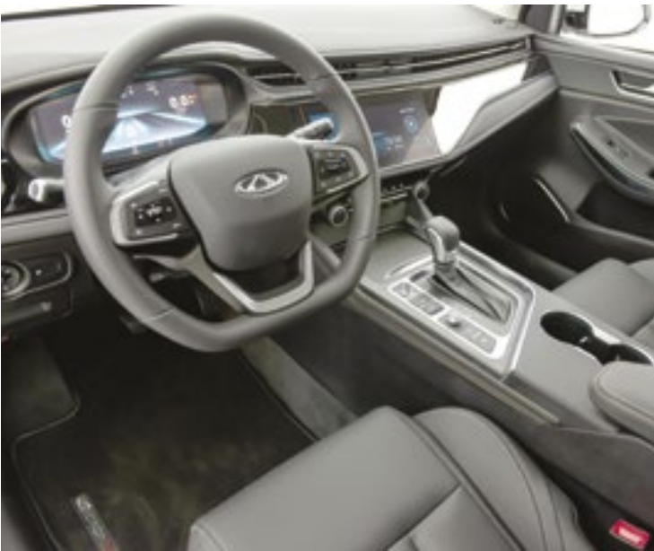
O volante do novo sedã da Caoa Chery é multifuncional com base reta e conta com ajuste de altura, mas não de profundidade
