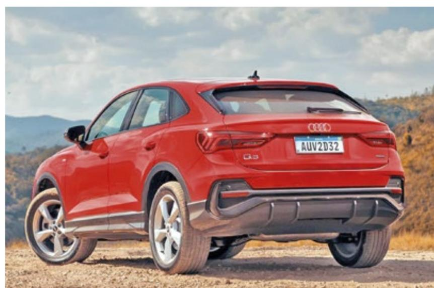
O Q3 Sportback tem 4,50 metros de comprimento, 1,84 metro de largura (2,02 metros com retrovisores), 1,56 metro de altura e 2,68 metros de entre-eixos
