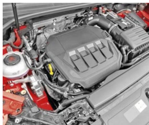
O motor é o EA888 2.0 TFSI a gasolina de quatro cilindros com injeção direta, duplo comando de válvulas
