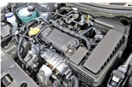
O motor 1.0 Firefly traz a arquitetura de duas válvulas por cilindro com geometria do conjunto aprimorada
