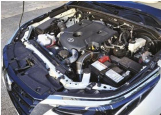
A linha SW4 é movida pelo turbodiesel 2.8L 16V com 204 cavalos de potência e 50,9 kgfm de torque a 2.800 rpm
