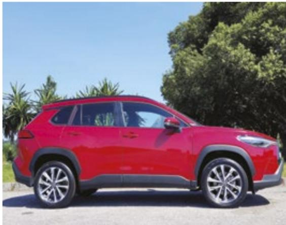
O Corolla Cross têm 4,46 m de comprimento, 1,82 m de largura, 1,62 m de altura e 2,64 m de distância de entre-eixos
