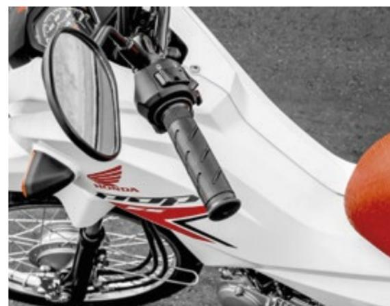
A partida elétrica traz a comodidade do acionamento do motor por intermédio de um simples botão localizado na direita do guidão
