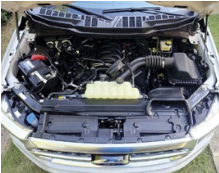
O motor 5.0 V8 Coyote a gasolina gera 405 cavalos a 6 mil giros e 56,7 kgfm de torque a 4.250 rpm
