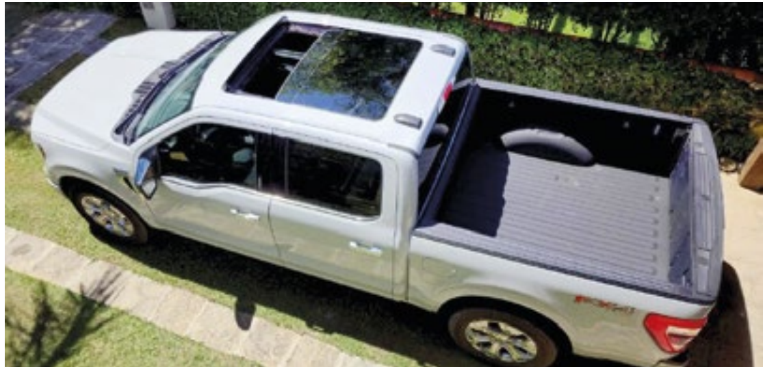
A caçamba tem 1,70 metro de comprimento e 1,52 metro de largura, com 53 centímetros de profundidade
