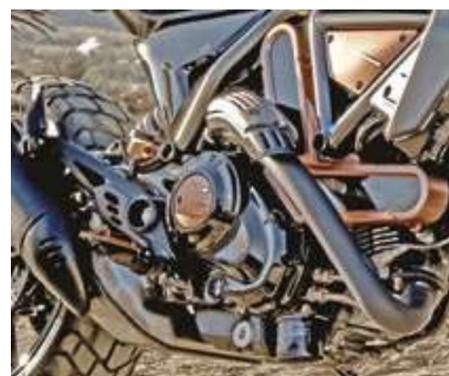
O motor bicilíndrico Desmodue de 73 cavalos de potência é realçado pelas novas tampas da embreagem
