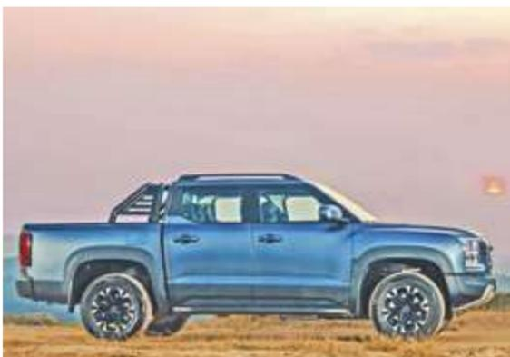
A Shark tem 5,45 metros de comprimento, 1,97 metro de largura, 1,92 metro de altura e 3,26 metros de entre-eixos
