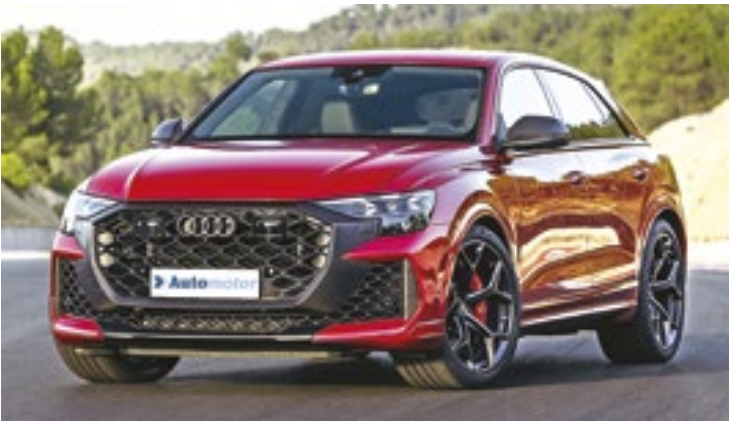
Novo RS Q8 tem motor 4.0 V8 biturbo de 640 cavalos e 86,7 kgfm
