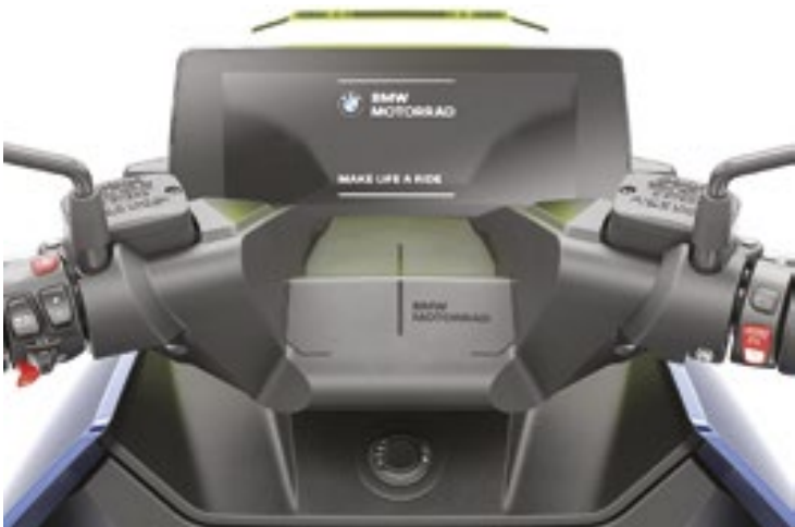
A CE 04 vem equipada de série com tela colorida de TFT de 10,25 polegadas com navegação por mapa e conectividade integradas
